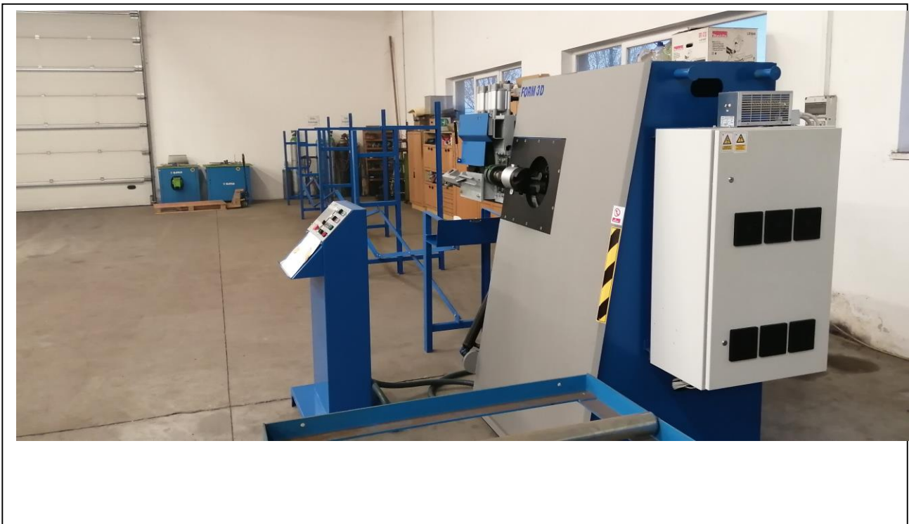
GALANOS FORM 3D betonacél hajlító gép
